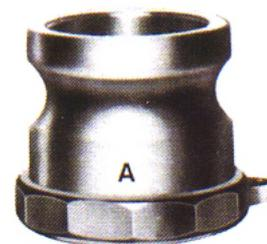
Questo tipo di raccordo è stato studiato per la giunzione rapida e sicura nel minor tempo possibile tra due tubazioni. Inserendo la versione maschio all'interno della versione femmina si avrà velocemente un accoppiamento meccanico a passaggio totale con il serraggio tramite due leve laterali, il cui eccentrico sul fulcro otterrà il definitivo bloccaggio, tramite una spina o un sistema a molla si ottiene il fermo di sicurezza delle due alette.
