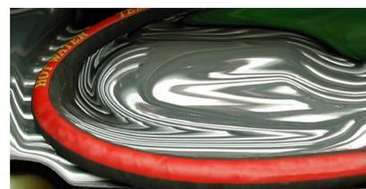
**Sottostrato:** liscio in gomma nera NBR resistente ai carburanti con contenuto aromatico non superiore al 50%, ai bio-diesel, alle benzine ecologiche con un contenuto massimo di composti ossigenati del 15%.
