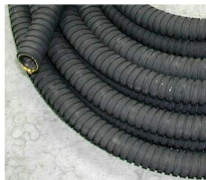
Struttura: gomma sintetica in EPDM resistente al calore, spirale metallica inserita, rinforzi tessili sintetici, copertura in EPDM con scanalature per una flessibilità estrema, resistente all'invecchiamento e agli agenti atmosferici.
