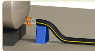
Il convient de supporter le tuyau derrière le raccord ou d'utiliser des raccords coudés.
