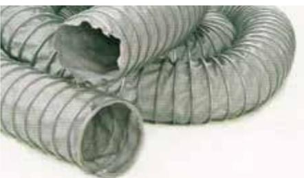
Tubo flessibile leggero realizzato con un doppio strato di un tessuto, esente da amianto, spalmato di POLIURETANO rinforzato da fili intrecciati di acciaio inox e da una spirale esterna in galvanizzato che conferisce una notevole protezione esterna all'abrasione. Resistente alla fiamma, non tossico. Flessibile e comprimibile assialmente. Difficilmente infiammabile, resistente alla lacerazione.
