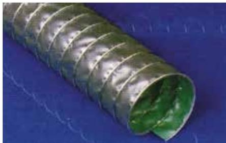
Tubo flessibile realizzato da un tessuto in poliestere molto resistente spalmato con sette strati di Hypalon rinforzato tramite spirale in acciaio zincato a caldo esterna.
